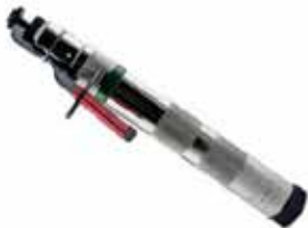
Abb 8: Penetrierender Bolzenschussapparat für Saugferkel: „Kleiner Blitz“
